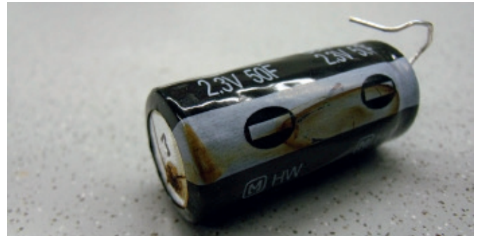
Abbildung 1: Kommerzieller Superkondensator nach einem Ausfalltest unter thermischer Überlast
