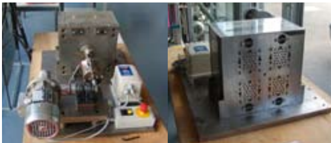
links: Motor mit Exzenter, rechts: Zwischenplatte mit Formeinsätzen
